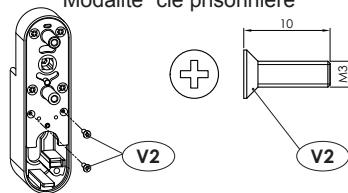
Installando entrambe le viti V2 si attiva la modalità "condominio" che consente l'apertura dell'infisso mantenendo la chiave inserita e ruotata sino a fine corsa e quindi abbassando la leva. Allestrazione della chiave la maniglia tornerà maniglia tornerà in folle.
